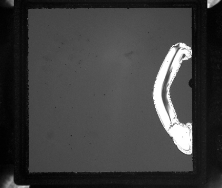
3C电子-摄像头滤光片破损
